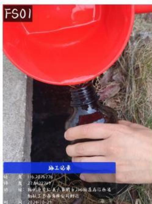
图 6-1 项目废水现场采样照片
